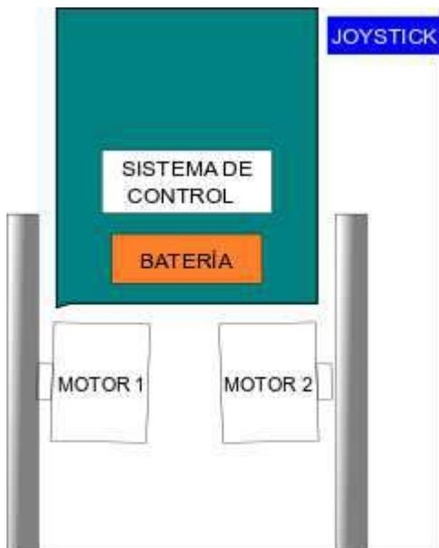
Figura 4 Componentes físicos y electrónicos de la silla
